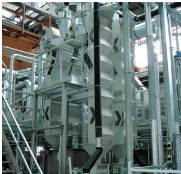
Fig. 1 : Séparateur gravimétrique HERBOLD faisant partie d'une installation de lavage pour bouteilles PET
