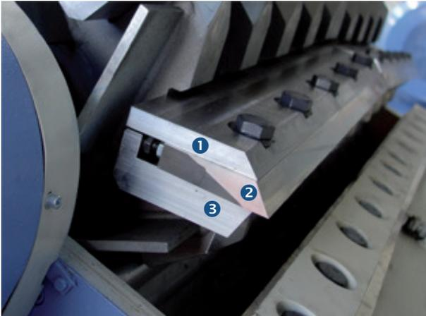
**Fig. 3:** ① Barre de pression pour couteaux
