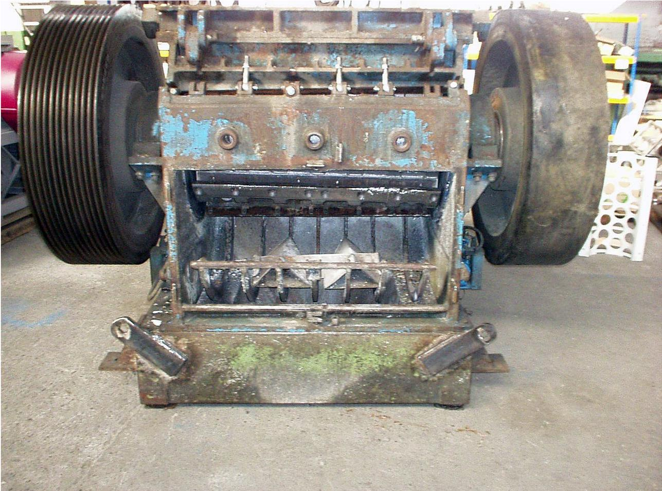
**Abbildung 2a:** Eine Schneidmühle SMS 80/120 vor der Aufarbeitung.
