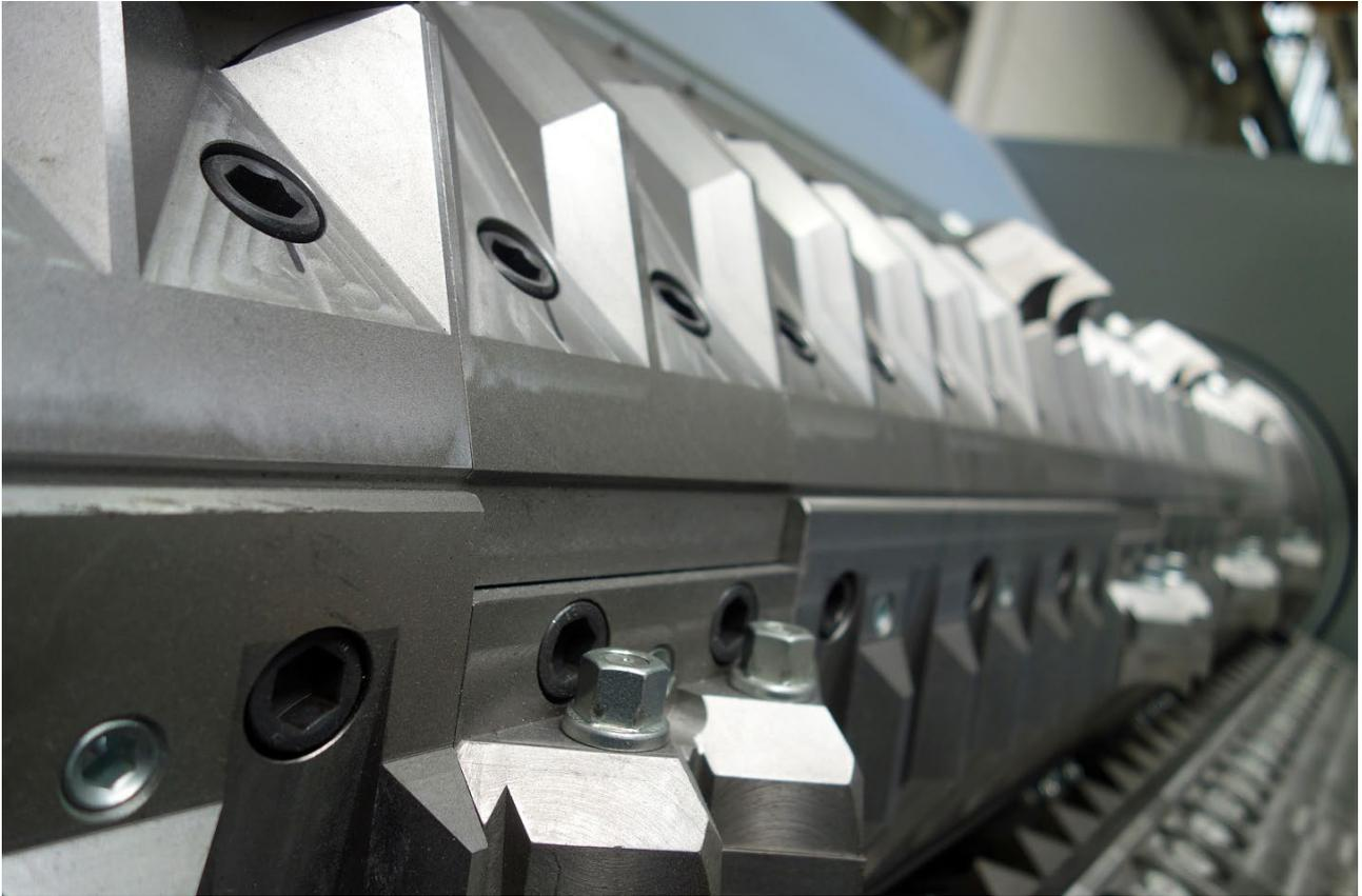
**Abbildung 1:** Rotor eines Einwellenshredders 60/210 mit aufgeschraubten Messerkassetten.
