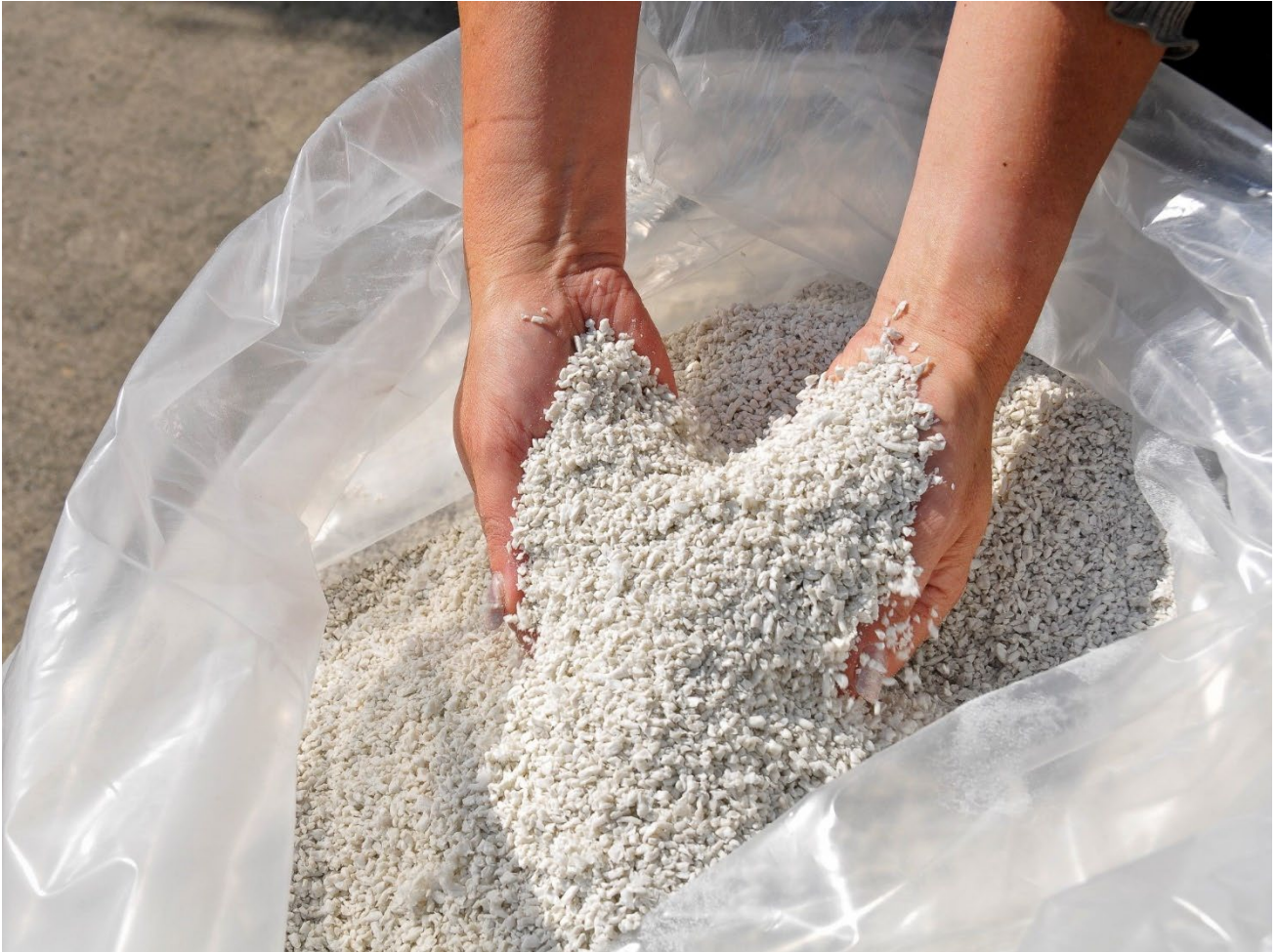
Abbildung 4: Durch den Agglomerationsprozesses entsteht ein rieselfähiges Mahlgut von hohem Schüttgewicht.
