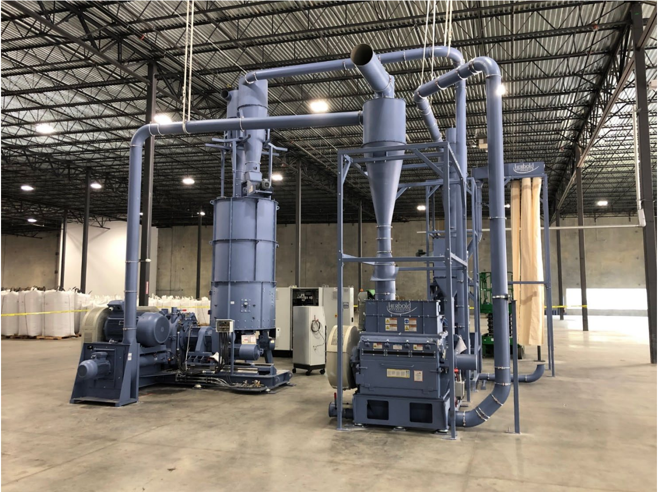
Abbildung 2: Agglomerationsanlage für Fasern, Feinanteile, Bändchen, Schaumstoffe, Folien, Pulver oder Späne.
